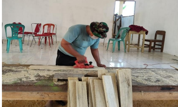
Gambar 2. Proses Pengetaman Kayu
