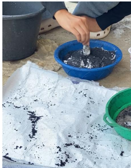
Gambar 5. Pencampuran serbuk TKKS dengan tepung tapioka
