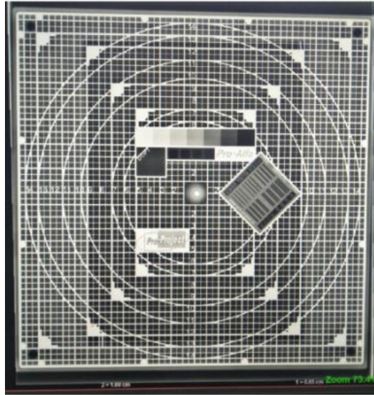
Gambar 2. Radiograf Pengujian Kolimator dengan Alat Collimator Alignment Test Tool dengan luas kolimasi 18x24 cm Pada FFD 100 cm di Instalasi Radiologi RS Bhayangkara Semarang
